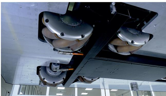
Bild 3. Als ideale Fahrwerksauslegung erweist sich die Kombination aus Mecanum Rädern auf luftgelagerten Schwingen. © Witte
